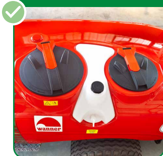
2 Tanköffnungen mit Tanksieb
